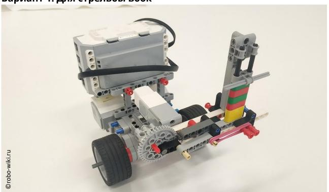
Установи две балки на 7 модулей вдоль тележки, после чего появятся отверстия для крепления пулемета вбок:
