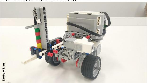
Закрепи модуль с пулеметом на передней раме:
