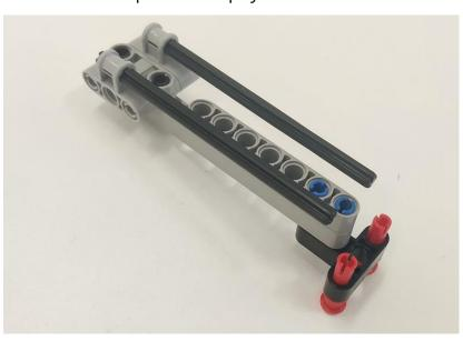
Для надежного выталкивания патронов соберем вот такую деталь (в настоящих магазинах используется пружина). Она будет выталкивать патроны собственным весом
